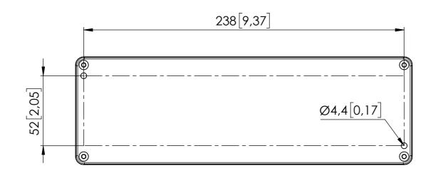
Schutzleiteranschluss: Deckel 1xM4x9
