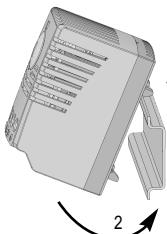
**Achtung!** Bei Geräten mit Wechslerkontakt kann bei nicht eingehaltener Reihenfolge bei der Montage eine mechanische Einwirkung auf das Bi-Metall stattfinden.
